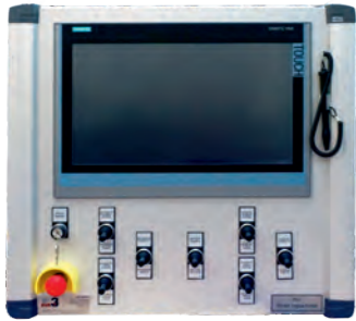
Пульт управления участком проката ПАО «ЧТПЗ»
